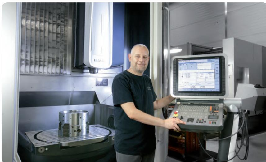
Hergestellt werden unsere Spannfutter auf modernen Bearbeitungsmaschinen – hier: 5-Achs-Fräsmaschine.
