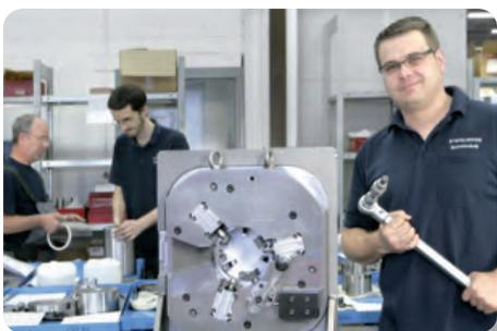
Immer das richtige Drehmoment – Montage eines STIEFELMAYER-Spannmittels.
