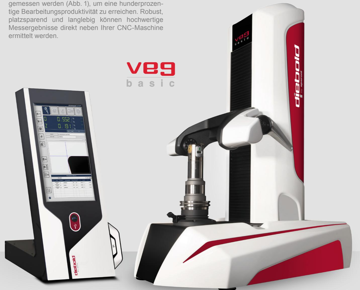
Übersichtlich, präzise und einfach zu bedienende Steuerung (Abb. 2), die speziell zur Optimierung aller Voreinstell- und Messvorgänge Ihrer Werkzeuge entwickelt wurde. Ein attraktives Multi-Touch-Display und das ergonomische Design ergänzen das VEG Basic auf effiziente Weise. Das Gerät wird mit einem Windows™ OS PC-basierten Display- und Sensorsystem mit HD-Kamera geliefert: Die "Essenz" des Messens.
