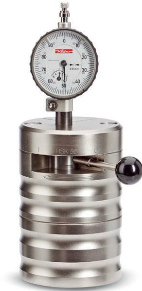
Mit diesem Messgerät kann bei der Weichbearbeitung oder in der Endkontrolle das Maß L5 mit konstanter Messkraft von der Spannschulter-schräge bis zur Plananlage geprüft werden. Das Gerät wird mit dem Einstellhorn (Seite 19) 76.750.xxx kalibriert.
