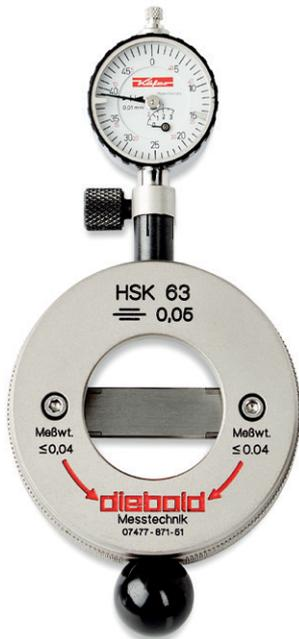
Mit diesem Messgerät kann bei der Weichbearbeitung oder in der Endkontrolle die **Nutbreite b1** und der **Mittensatz** vom Bezugspunkt „Kegelmantel“ aus geprüft werden. Es wird keine Einstellehre benötigt.
