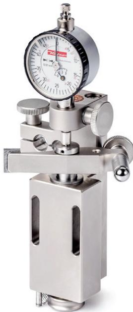
Die Messvorrichtung wird seitlich an den Messkopf geschraubt. Hiermit können die Greifermaße  $d_{11}$  und  $f_3^*$  geprüft werden.
