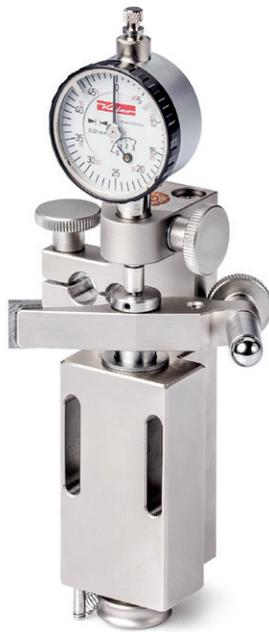
Die Messvorrichtung wird seitlich an den Messkopf geschraubt. Gleichzeitig kann der Greiferrillendurchmesser  $d_5^*$  und der Greiferrillenabstand  $f_1^*$  geprüft werden.
