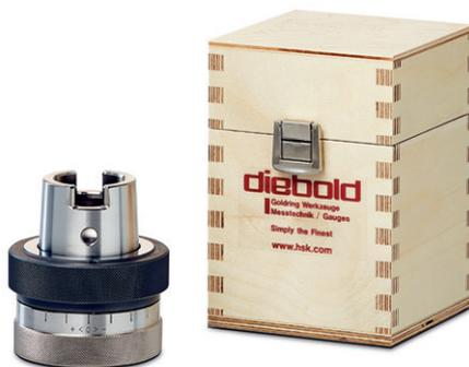
Zum Überprüfen der Zugstangenposition und Einstellen des Überwachungssensors „Werkzeug gespannt“. Die Längenjustierung der oberen und unteren Toleranzgrenzen kann in Schritten von 0,05 mm erfolgen.
