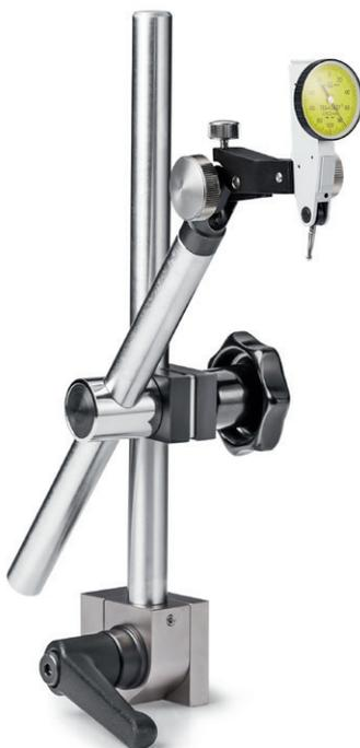
Der Messständer wird direkt am hinteren Teil des Messgerätes angeschraubt. Mit einer Messuhr kann der Rundlauf der Werkzeugseite geprüft werden.
